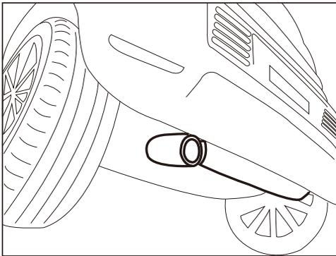
TEZZOプレミアムマフラー for ルノートウインゴは、サイレンサー内に部屋を作る構造ではなく、排気音を抑える目的でパイプを長くし、さらに必要に応じてUターンさせて、美しい管楽器のような複雑な取り回しを採用しています。
