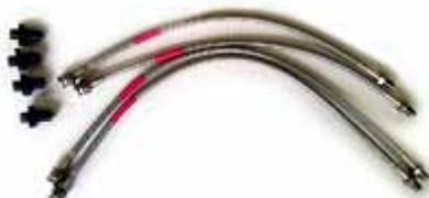
純正に多く使われる、ゴム製のブレーキホースは圧力を加えた時に膨張しやすく、マスターシリンダーで発生させた圧力を十分にキャリパーへ伝えることが出来ません。ステンメッシュのオリジナルブレーキホースに交換していただくことで、膨張が減りペダルストロークが少なくなります。それにより、特に踏み始めの反応が良くなり、ブレーキが従来より効くように感じていただけます。また、カチッとしたフィーリングを得ることが出来ます。ブレーキ操作がシビアなスポーツ走行ユーザー向けと思われる方も多いと思いますが、踏んだら踏んだだけ、ゆるめたらゆるめただけリアな反応となりますので、通常走行でもその扱いやすさの違いを体感頂けます。ブレーキの負担が大きい状況下(高速走行時、下り坂、乗員や荷物での重量増加)において効果的です。ABSやブレーキサポートなどの安全装置の効果も十分に発揮できるので、安全性も向上します。ブレーキに不安が残る方はブレーキホースの交換もおすすめ致します。
