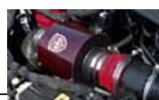
TEZZOカーボンエアインテークシステムは、センターインテーク構造を採用した布フィルター式エアクリーナーと遮熱性に優れたカーボンエアボックスから構成されるエアインテークシステムです。
