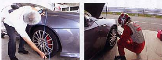
プレラ2.2に装着してサーキットテストしたモノブロックビッグキャリパー。走行の度に温度を計測してチェックを重ねるのだが、結果温度は安定していた。
