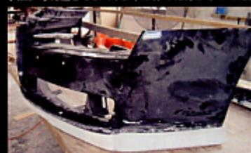
ミニチュアで形を決めたら、次は実車で形を作っていく。パテで形を整え、プロトタイプを作る。形が決まるまで、何度も修正が加えられる地道な作業。
