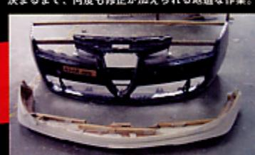
こうして出来上がったプロトタイプのスポイラー。これは型取り用として作ったもので、これにファイバーを貼り付けて、実際のスポイラーを製作する。
