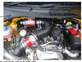
これがTEZZO カーボンエアインテークシステム for ABARTH500/595です。 特殊構造により、カーボンボックス内のエアクリーナーフィルターの表面積を増加させ、 多くのフレッシュな空気をより早くエンジンルームに取込みます。
