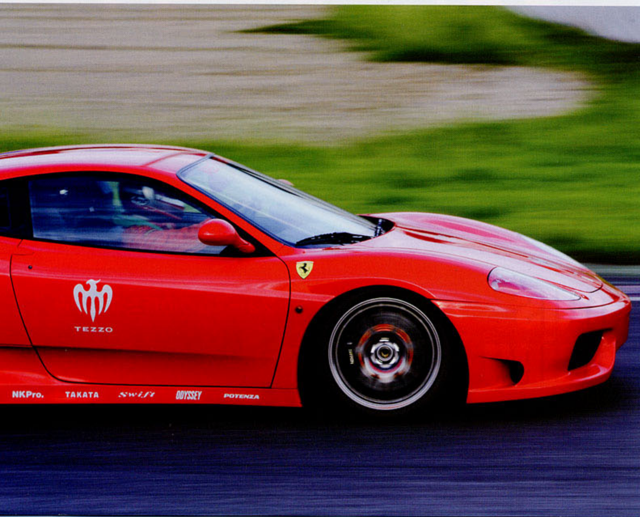
上が装着したブレーキ。これはフロントで、標準の330mmから355mmへとサイズアップ。センター部分をTEZZOの意にしたため、左のメインカットのようにホイールセンターが赤く輝いているのが美しい。下は左がメカニックたちの作業。右はブレーキオイルでBPブレーキスーパードット4を使用している。
