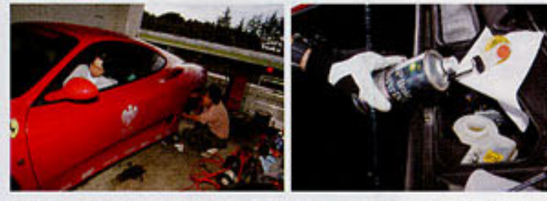
上が装着したブレーキ。これはフロントで、標準の330mmから355mmへとサイズアップ。センター部分をTEZZOの意にしたため、左のメインカットのようにホイールセンターが赤く輝いているのが美しい。下は左がメカニックたちの作業。右はブレーキオイルでBPブレーキスーパードット4を使用している。
