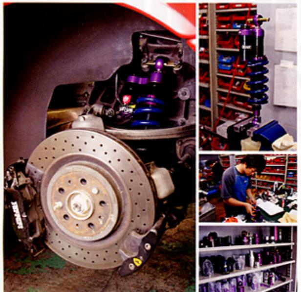
今回装着したデモカー両の製作は、データ採取のため別タンクを持ち、ロースピードに加えてハイスピードのジャッキもついた仕様がおこられる。もちろん、別タンク内にクアンタムの特徴であるセカンドビストンを有する仕様だ。ここでデータ採取した仕様は、シングルボディにも反映される。丁寧に時間をかけて造り上げた究極の定まりである。
